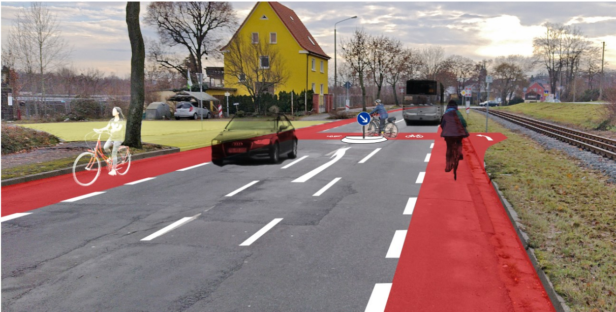
Abbildung 76: Visualisierung der Bahnhofstraße mit Schutzstreifen und Querungsanlage zum Dreibrückenweg
