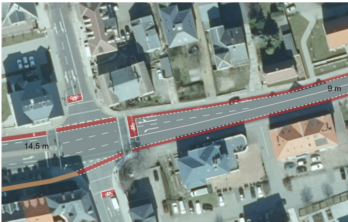
Abbildung 113: Markierungslösung auf der Promenade im Bereich Lutherstraße
