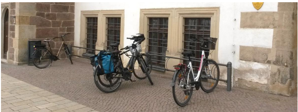
Abbildung 60: Neumarkt /Rathaus: Städtisches Standardmodell Vorderradhalter ist nicht ideal: Schäden an der Felge können leicht entstehen.
