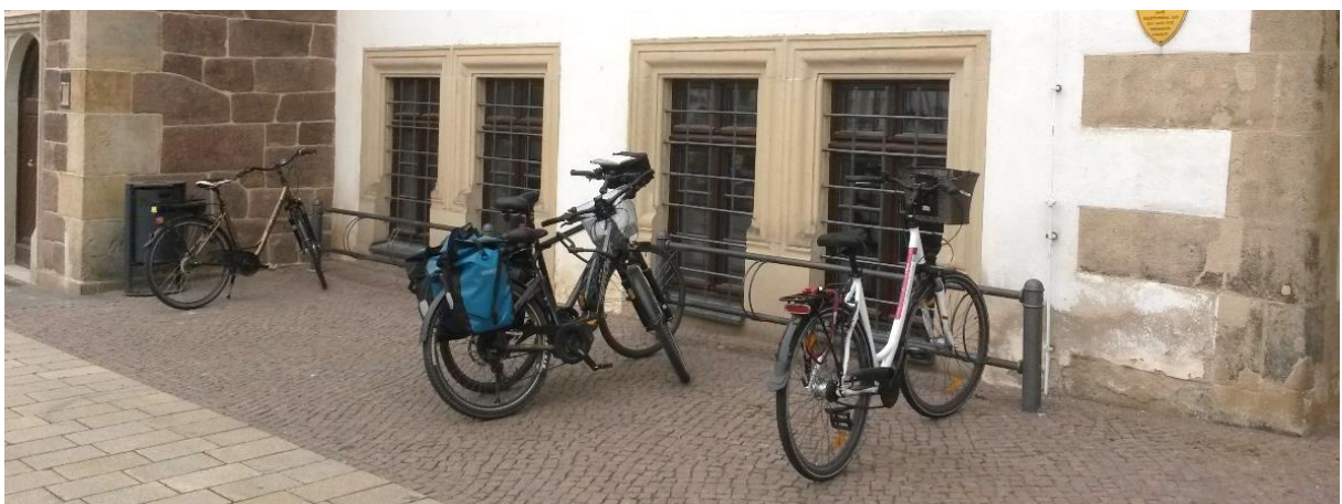
Abbildung 60: Neumarkt /Rathaus: Städtisches Standardmodell Vorderradhalter ist nicht ideal: Schäden an der Felge können leicht entstehen.
